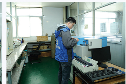
直读光谱仪 (材料化学成分分析)
