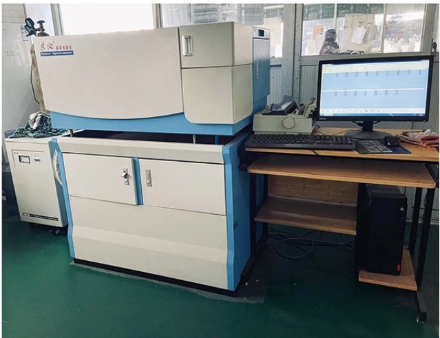
直读光谱仪(材料化学成分分析)
