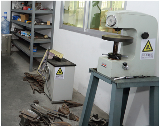
洛氏硬度检测仪（产品硬度测试）
